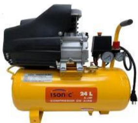
ISONIC: COMPRESOR DE AIRE USO DOMESTICO 24 LITROS 2 1/2 HP (6 GAL.), 110V-60HZ 80P (40MM), 8 BAR (116 PSI). PISTON 1*42MM TAMAÑO 240*420MM COLOR AMARILLO
