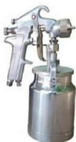
Pistola para pintar. Boquilla estándar 1.8mm presión de funcionamiento: 3,5 -5,0 bar (50-72psi), ancho del patrón: 200-250mm, consumo de aire: 7,0-12,0 cfm, tanque 1000mL, caudal 198-340L/min.
