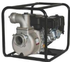
MOTOBOMBA DE GASOLINA DE 7HP DIÁMETRO INTERNO DE ENTRADA Y SALIDA: 80MM (3"), ELEVACIÓN DE LA BOMBA: 28M, ALTURA DE SUCCIÓN: 7M, CAPACIDAD MÁXIMA: 60M3/HR, MOTOR: LT170F, DIMENSIÓN: 520X380X450CM, PESO NETO: 25KG
