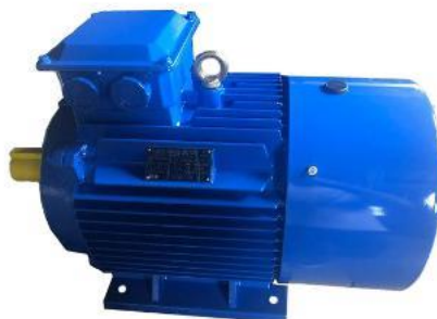
MOTOR ELECTRICO TRIFASICO DE CORRIENTE ALTERNA AC 0,75KW (1HP) 1695RPM, 220V/440V, 60Hz, B3, diametro del eje: 19mm, largo del eje: 125mm. Nivel de eficiencia de energia E1. Tamaño de caja: L315mm*W215mm*H270mm
