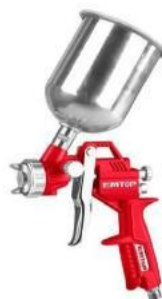
Pistola para pintar. Boquilla estándar 1.5mm presión de funcionamiento: 3,5 -5,0 bar (50-72psi), ancho del patrón: 180-250mm, tanque 600mL, caudal 99-240L/min.
